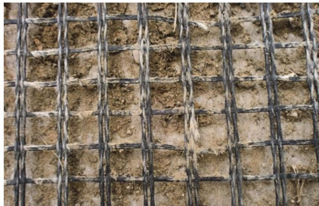
Figure 7. Détail de la grille de renforcement après rupture du géoconteneur.
